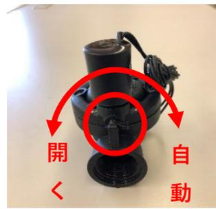
ドロット電磁弁25A
