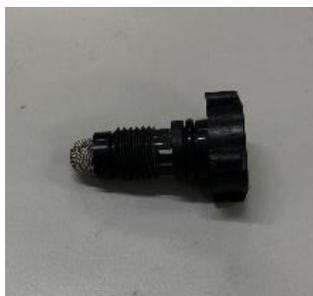
電磁弁フィルター外した物
